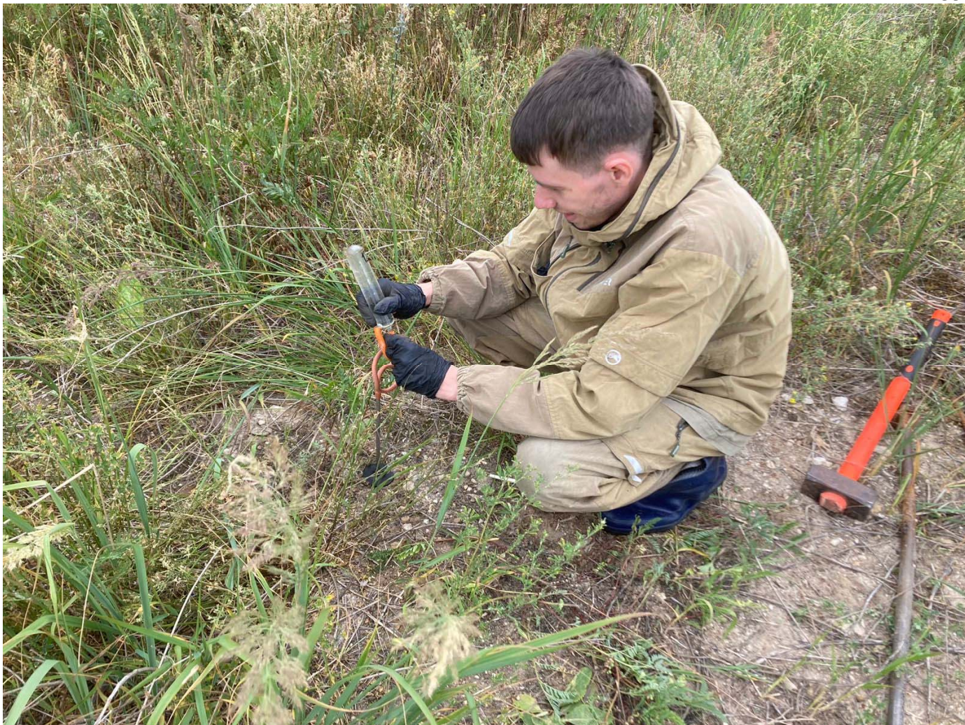
Рисунок 4.1 – Отбор газовой пробы грунтового воздуха из шпура
