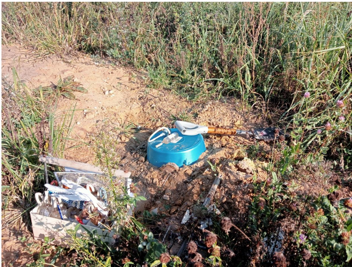
Рисунок 3.1 – Измерение эмиссии биогаза из грунтового массива в атмосферу.
