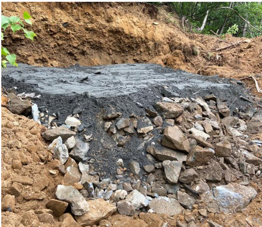
Рисунок 4.1.3.2-4. Отсыпка компонентов Продукции на площадку ОПИ АО «ОРК».
