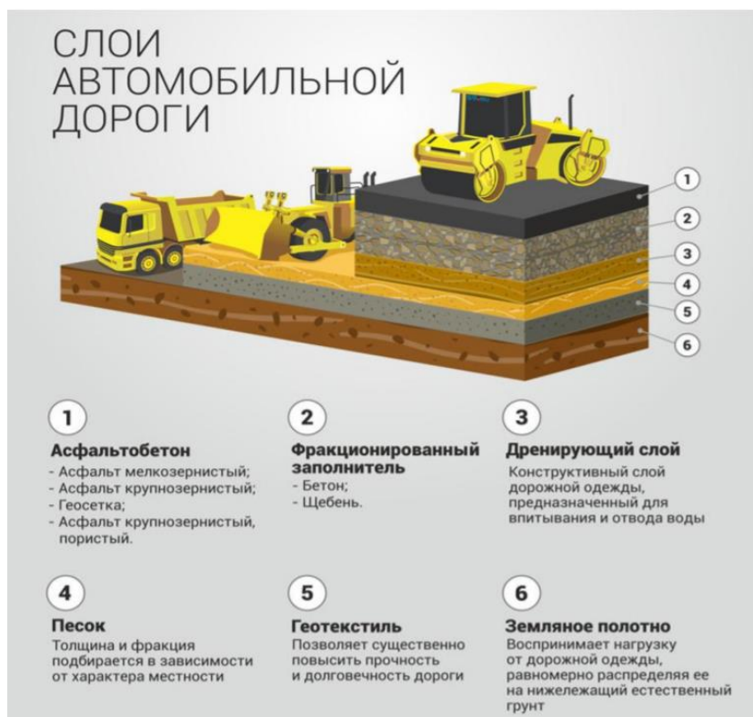
Рисунок 4.2.-1 Слои автомобильной дороги
