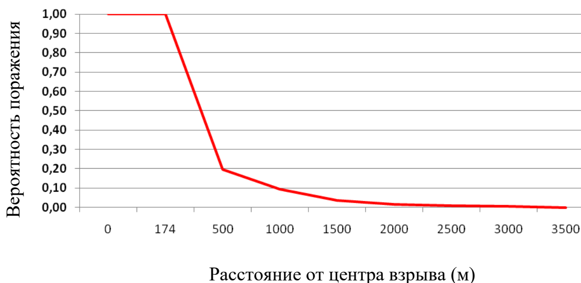
Рис. 3.9 График зависимости вероятности поражения ударной волной (с летальным исходом) от удалённости от места взрыва в зоне 2
