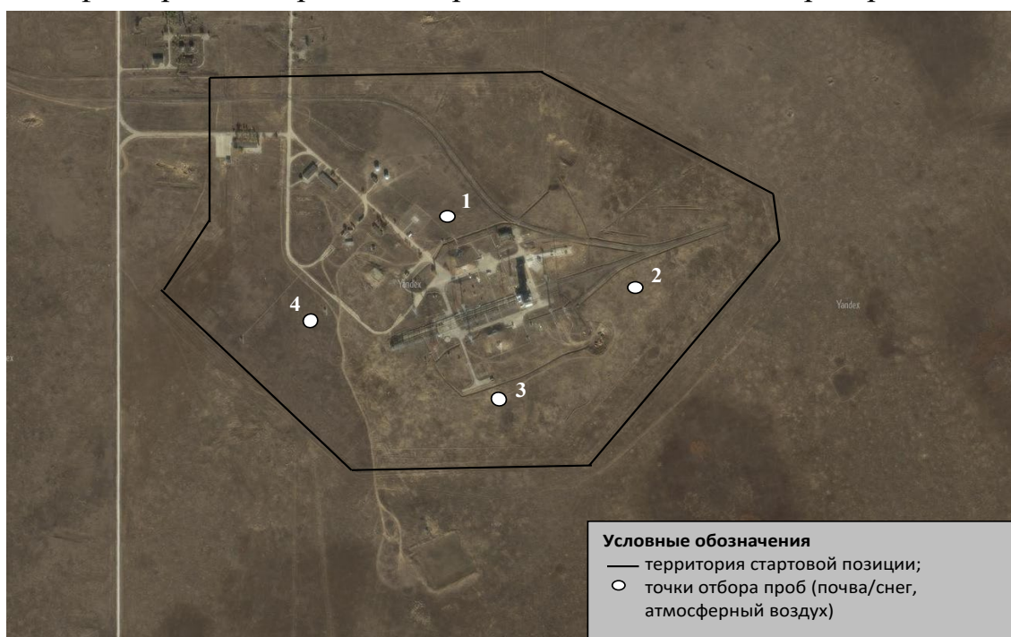
Рис. 5.1 Схема отбора проб в районе расположения СП
