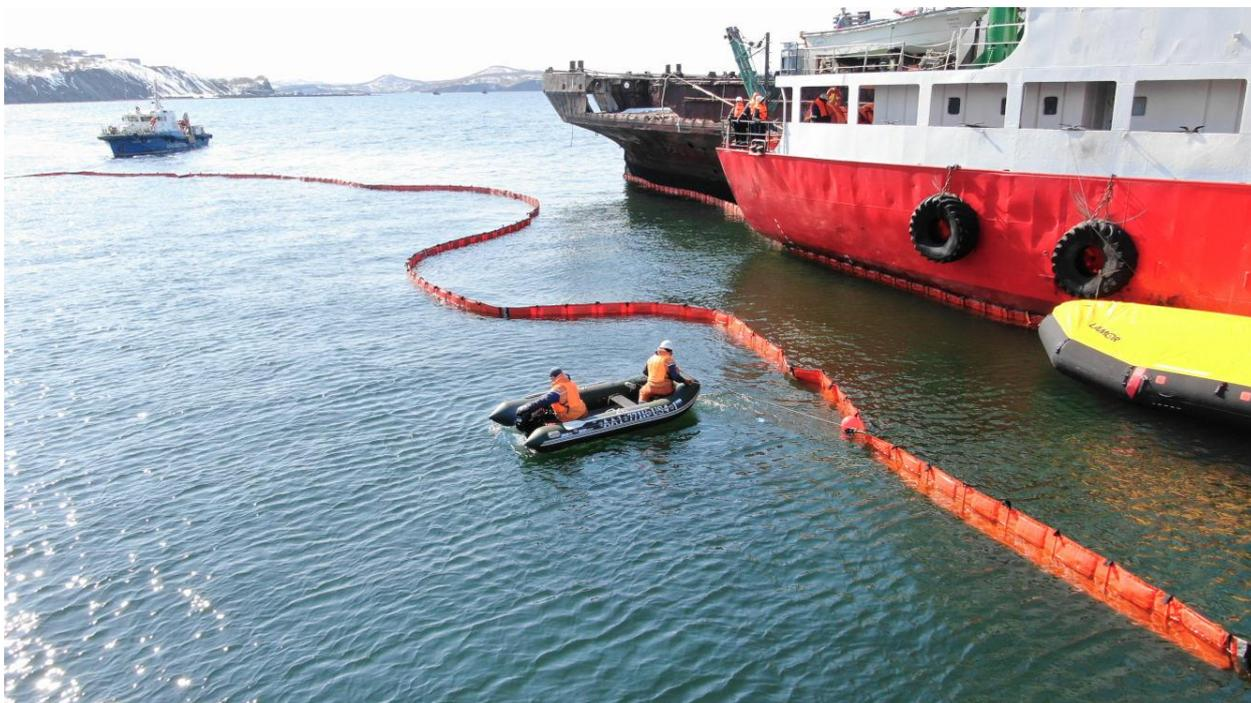
**Рисунок 3.6. Постановка бонового ограждения при бункеровке в акватории**
