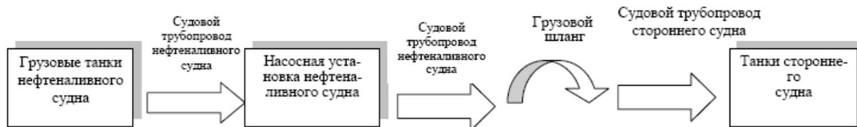
Рисунок 3.3. Технологическая схема отгрузки топлива
