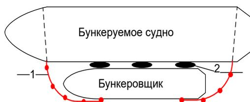
**Рисунок 3.5. Ограждение боными судов при бункеровке в акватории**
