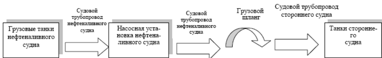
Рисунок 4.6. Технологическая схема отгрузки топлива
