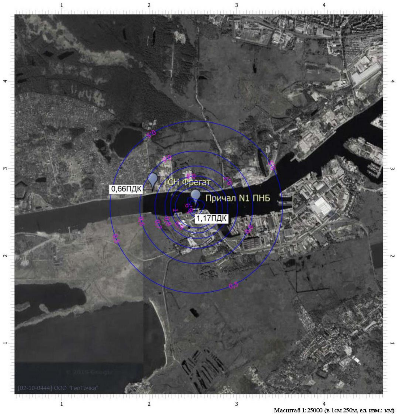
Рисунок 5.8. Схема концентраций при рассеивании диоксида азота в атмосфере в ситуации бункеровки на акватории порта Калининград (портовая нефтебаза)
