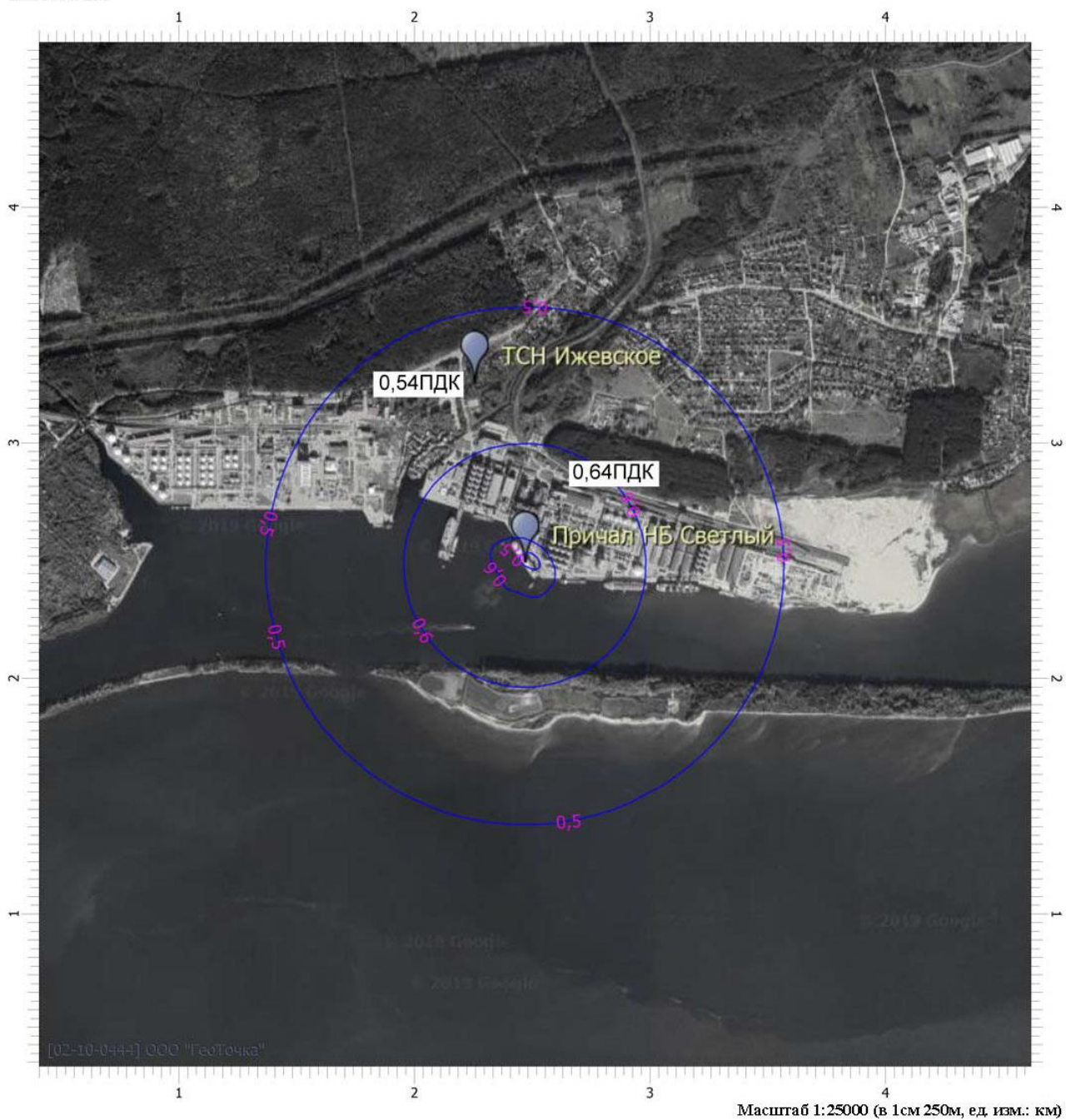
Рисунок 5.9. Схема концентраций при рассеивании диоксида азота в атмосфере в ситуации бункеровки на акватории порта Светлый (портовая нефтебаза)
