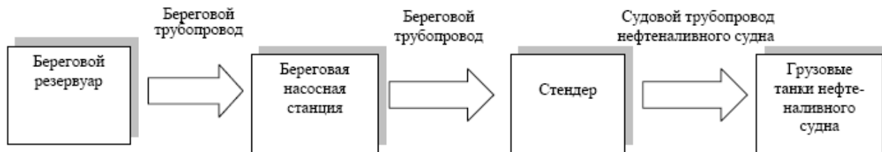
Рисунок 4.5. Технологическая схема загрузки топлива
