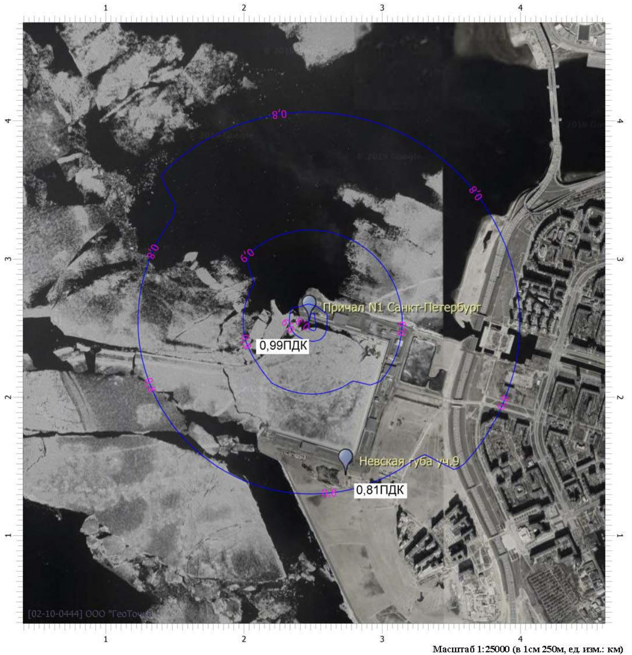
Рисунок 5.14. Схема концентраций при рассеивании диоксида азота в атмосфере в ситуации бункеровки на акватории порта Пассажирский порт СПб (Невская губа)
