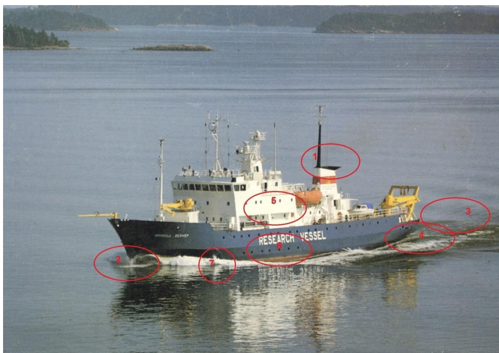
Рисунок 13.1. Основные источники воздушного шума судна
