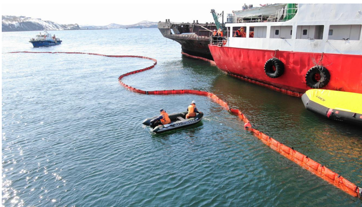
Рисунок 4.9. Постановка бонного ограждения при бункеровке в акватории
