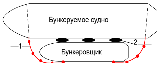
Рисунок 4.8. Ограждение бонами судов при бункеровке
