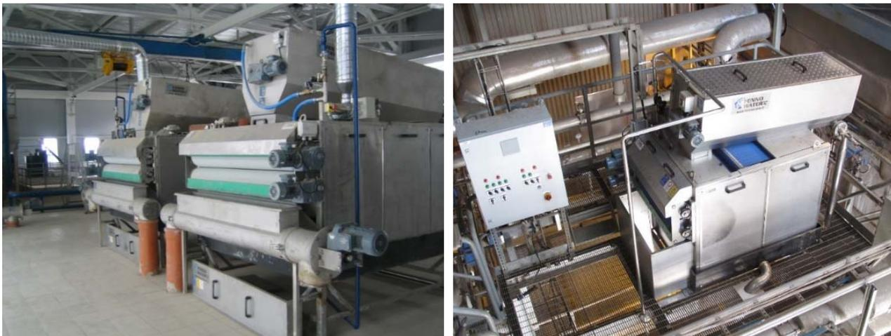
Рис. 4.6.1. Ленточные фильтр-прессы, заблокированные с барабанными сгустителями.
