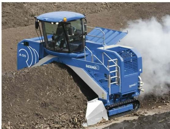
Рисунок 4.7.2.2 – Ворошитель компоста (пример)
