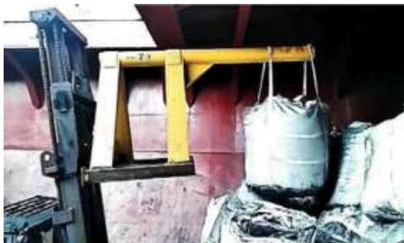
Рис. 2.23.6 - Специальное приспособление на грузовой раме а/п
