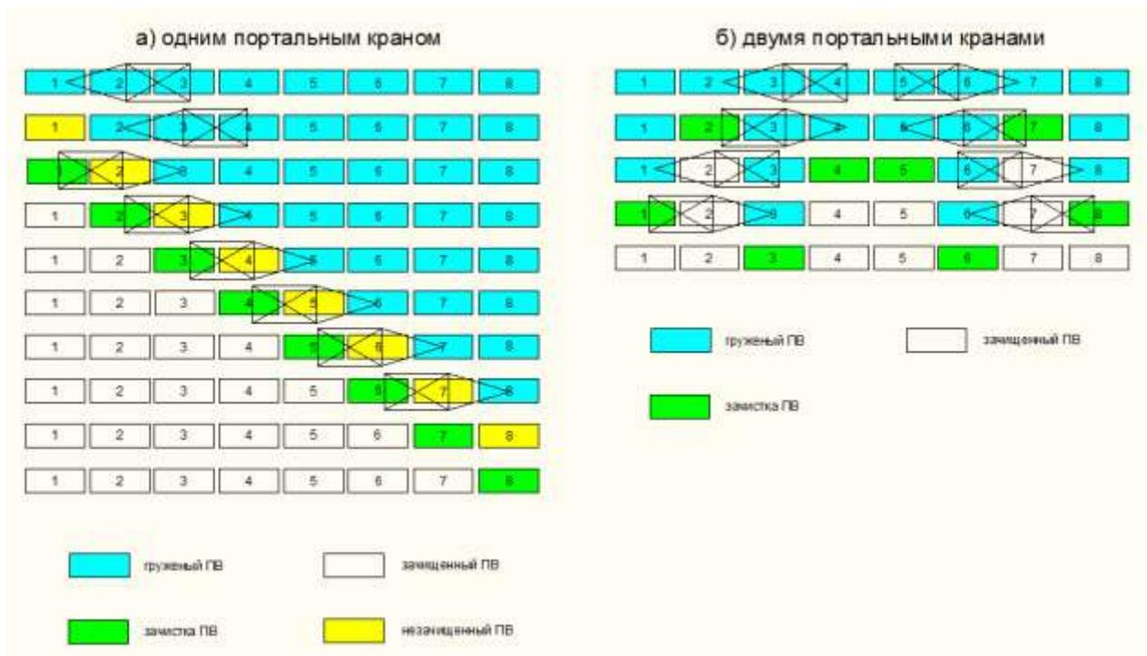
**Рис. 2.26.3 - Последовательность выгрузки груза порталными кранами, манипуляторами при совмещении с зачисткой полувагонов**
