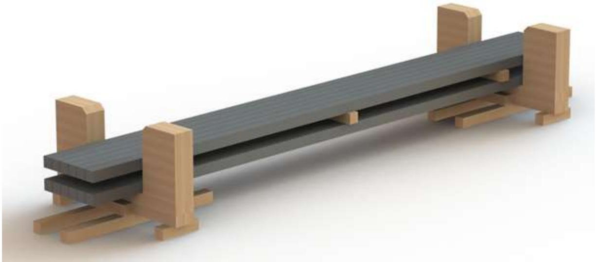
**Рис. 2.11.6 - Формирование многослойного подъема при погрузке заготовки в подпалубное пространство**
