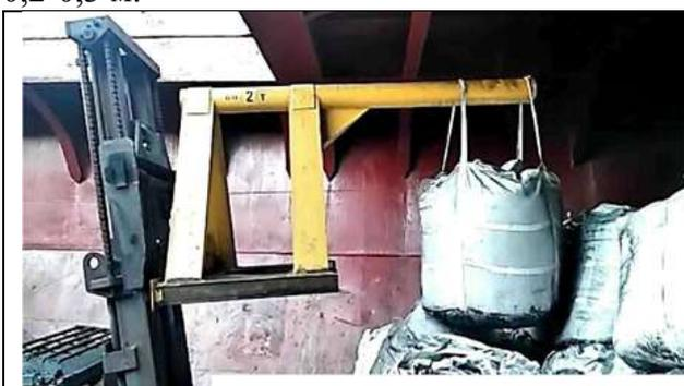
Рис. 2.24.6 - Специальное приспособление на грузовой раме а/п.
