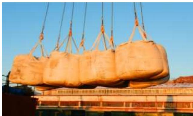
Рис. 2.23.3 - «Подъём» состоит из восьми МК, грузоподъёмные проушины которых навешены на крюки рамы
