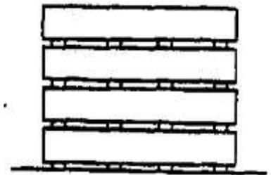
Рис. 2.8.6 – Складирование пачек, имеющих поперечные салазки
