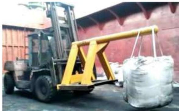
Рис. 2.23.7 - Перемещение МК при помощи специального приспособления
