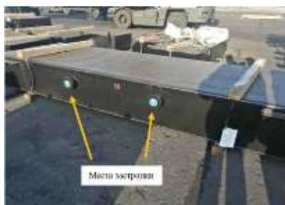
**Рис. 2.25.1 - Места застройки неупакованного узла кранового противовеса.**
