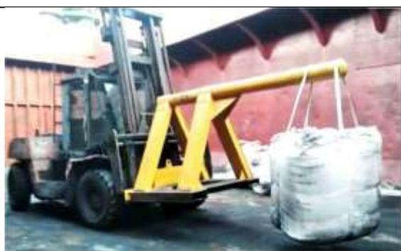
Рис. 2.24.7 - Перемещение МК при помощи специального приспособления.
