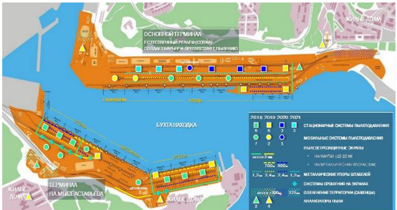
Рисунок 4. Расположение оросительных пушек и ограждений
