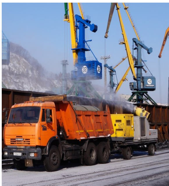
Рисунок 18.4.5 - Мобильная система пылеподавления SMI Super PoleCat, УП/М- 718- X1
