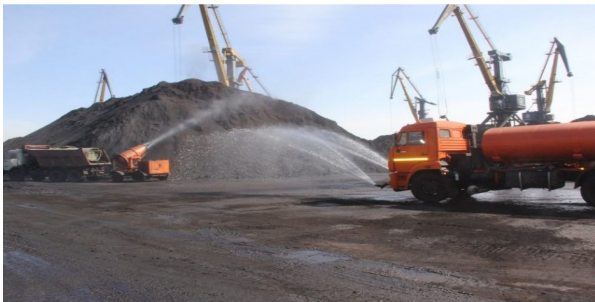
Полив и орошение штабелей угля и внутрипортовых дорог Рисунок 18.4.17 - Механическая и/или вакуумная уборка
