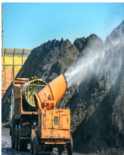
Рисунок 18.4.5 - Мобильная система пылеподавления SMI Super PoleCat, УП/М- 718- X1
