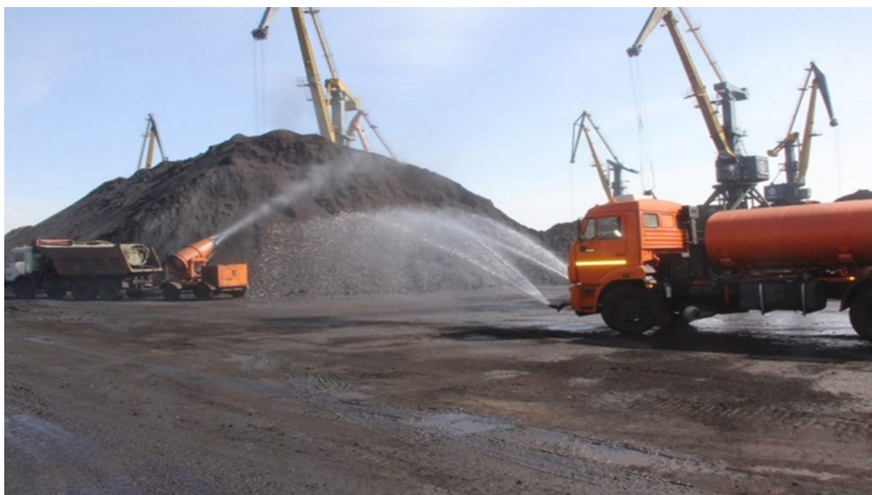
Рисунок 18.4.2 - Полив и орошение штабелей угля и внутрипортовых
