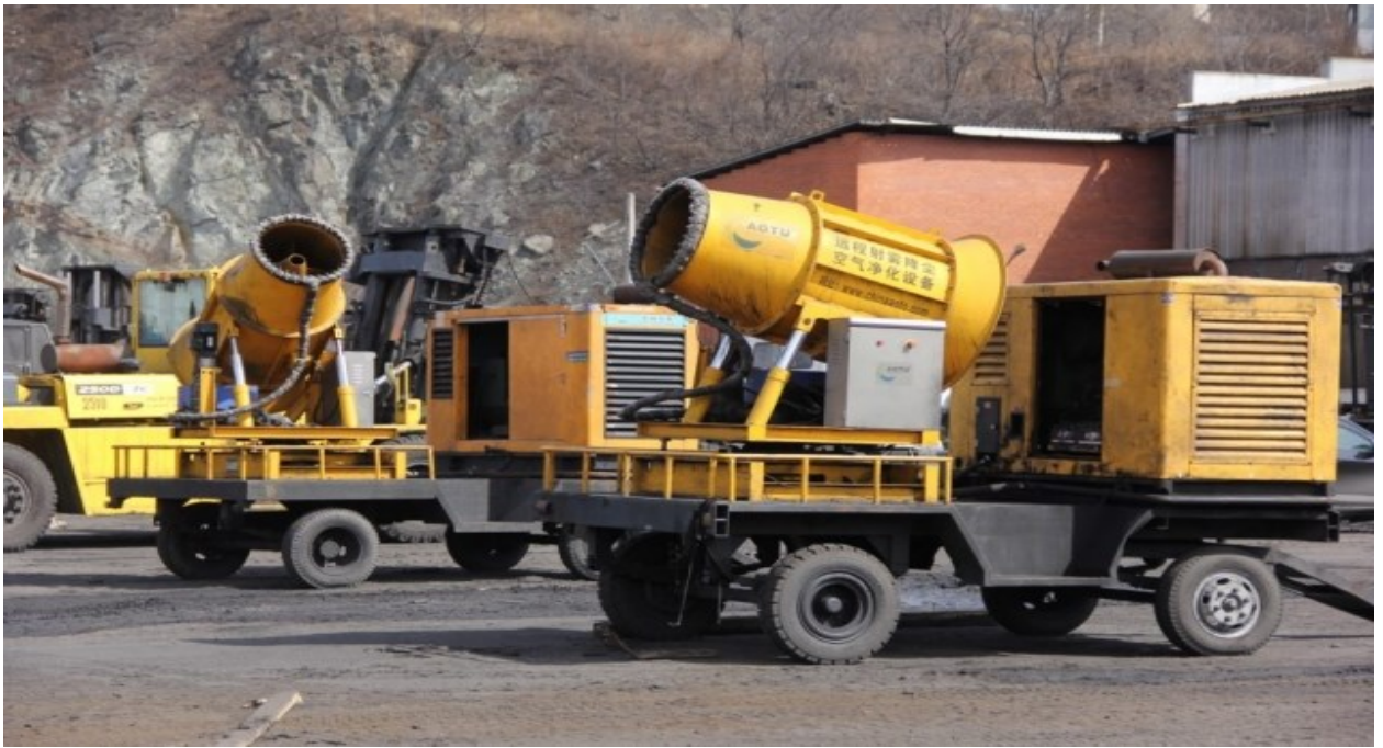
Рисунок 18.4.3 - Внешний вид разбрызгивателя AS-65 с системой подавления пыли
