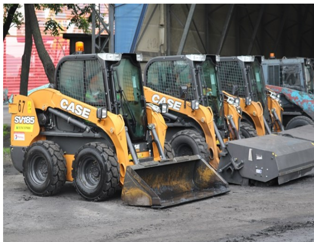
Мини погрузчики для уборки просыпей угля при погрузке
