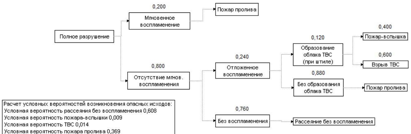
Рисунок 3 - Дерево событий для полного разрушения оборудования, содержащего нефтегазовую смесь
