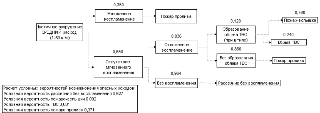
Рисунок 2 - Дерево событий для частичного разрушения оборудования, содержащего нефтегазовую смесь
