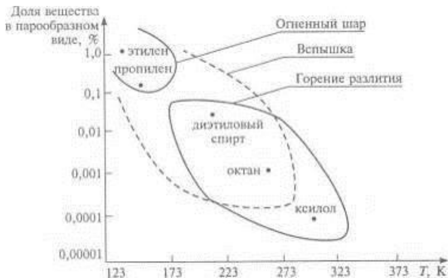
Рисунок 4 - Зависимость характеристик пожара от температуры кипения вещества
