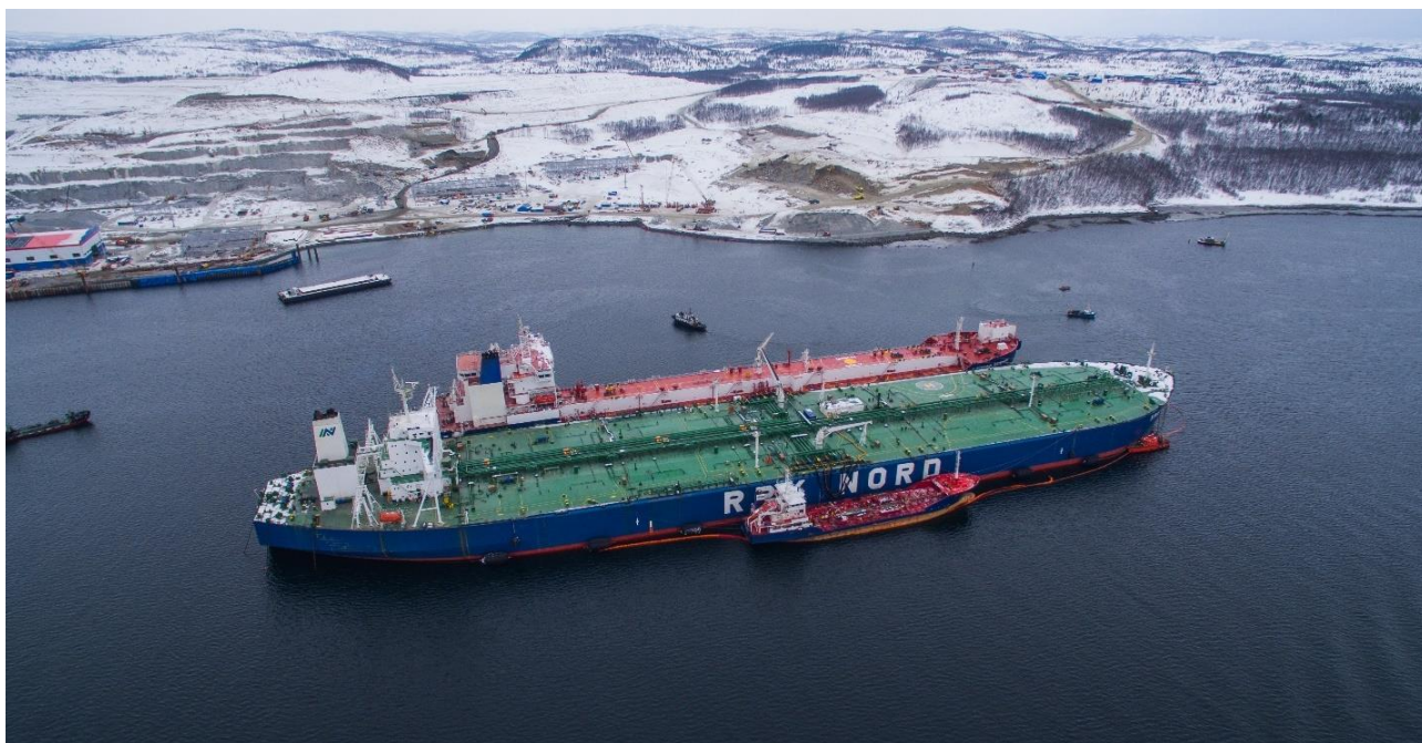
Рисунок 2.5. Перевалка нефти с борта танкера «Штурман Щербинин» на РПК «Норд» в Кольском заливе
