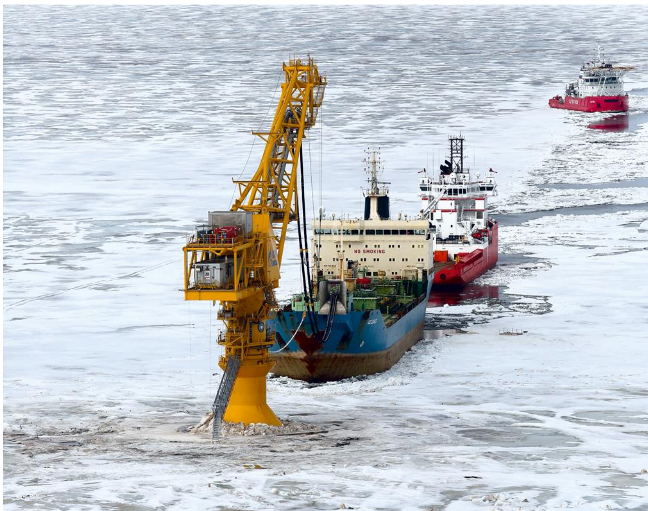
Рисунок 2.3. Обеспечение загрузки танкера двумя ЛСО в грузовой зоне терминала
