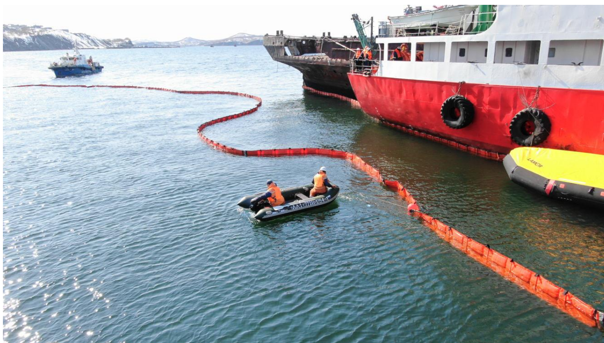
Рисунок 4.19. Постановка бонового ограждения при бункеровке в акватории
