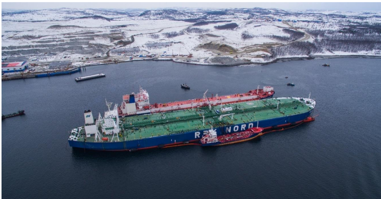
Рисунок 4.21. Перевалка нефти с борта танкера «Штурман Щербинин» на РПК «Норд» в Кольском заливе
