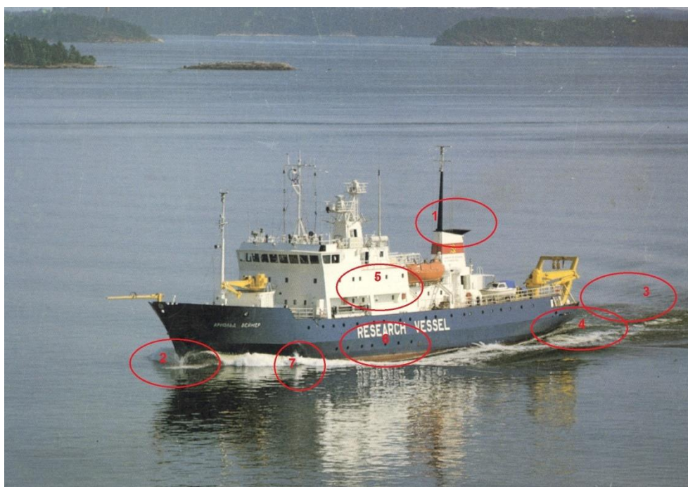
Рисунок 13.1. Основные источники воздушного шума судна
