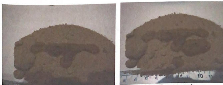
Рис. 2. Реакция песка с соляной кислотой (слабо вскипает)
