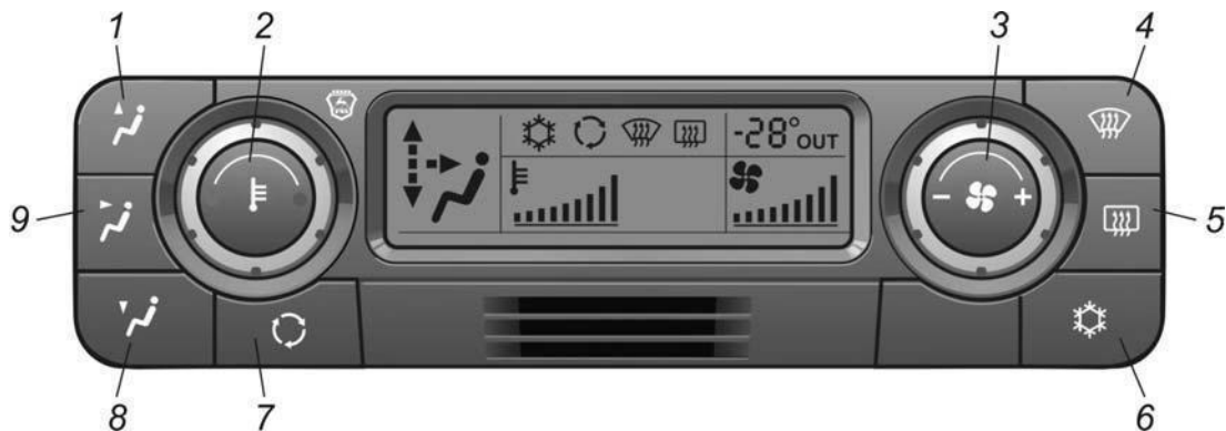
Рис. 8.1. Пульт управления отопительно-вентиляционной и климатической установкой
