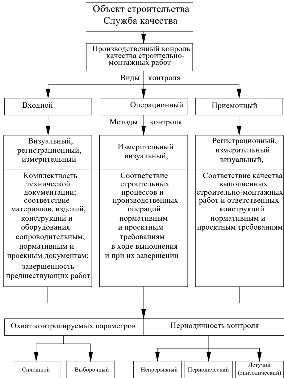
Рисунок 12.1 - Схема производственного контроля качества строительно-монтажных работ
