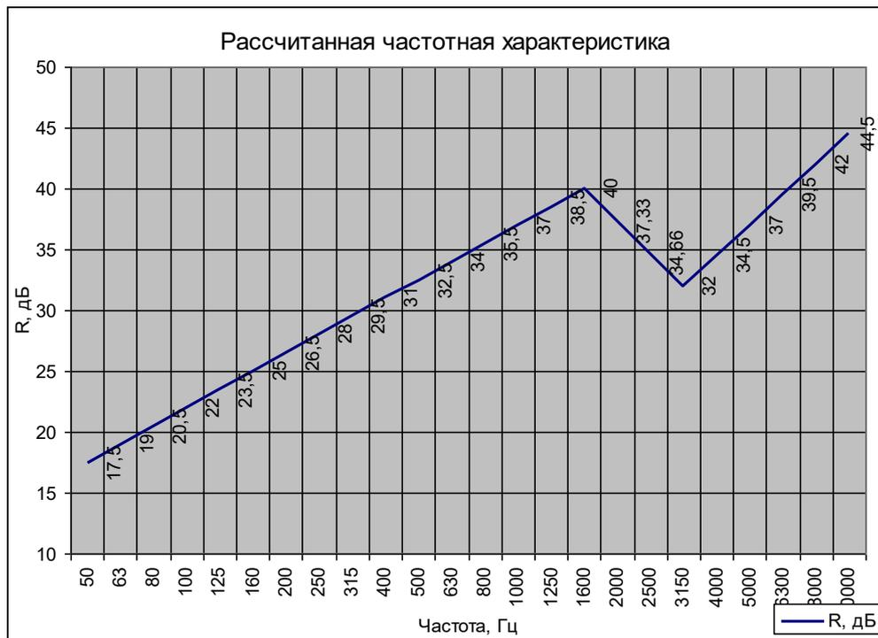
В диапазоне частот изоляция воздушного шума для металлических ворот составит:
