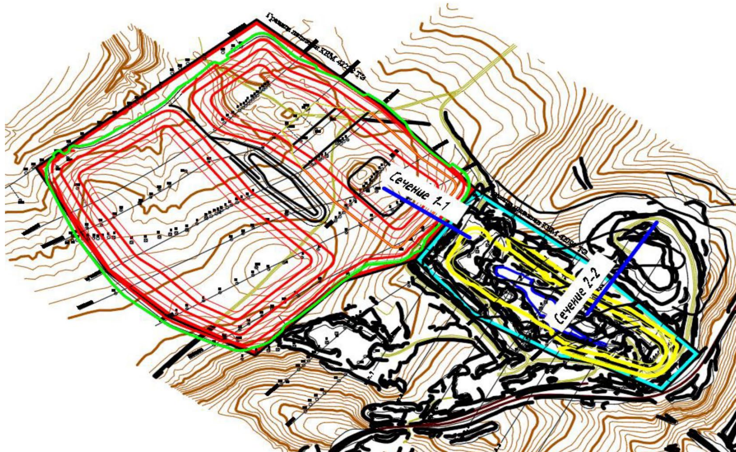
Рисунок 3.3 – Расположение расчетных сечений для системы борт-отвал
