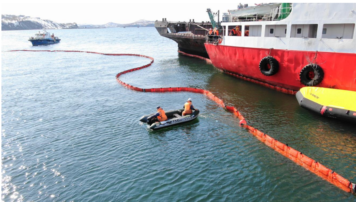
Рисунок 3.6. Постановка бонового ограждения при бункеровке в акватории
