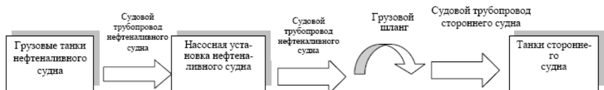
Рисунок 3.3. Технологическая схема отгрузки топлива
