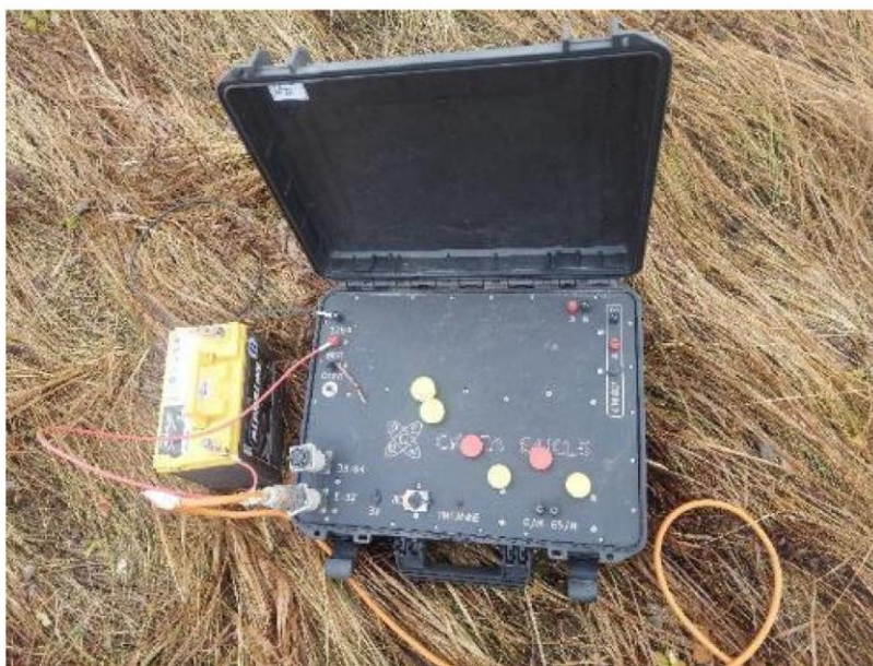
Рисунок 4.3. Многоэлектродная электроразведочная станция «Скала-64К15»
