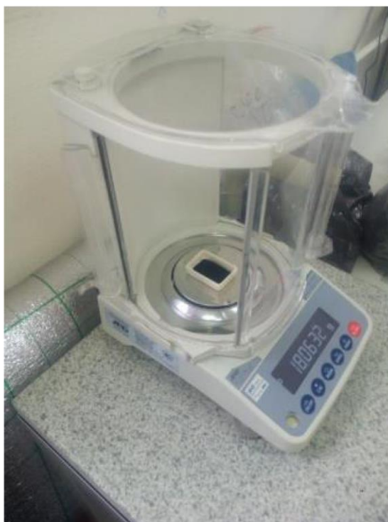
Рисунок 3.11. Взвешивание исследуемого образца на лабораторных весах
