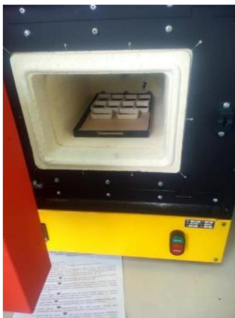
Рисунок 3.12. Угольные пробы в муфельной печи
