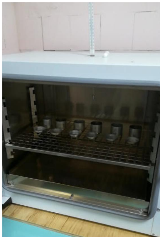
Рисунок 3.10. Навески исследуемых образцов в сушильном шкафу
