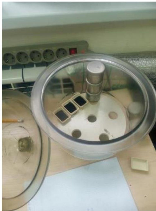
Рисунок 3.13. Образцы угля, помещенные в эксикатор
