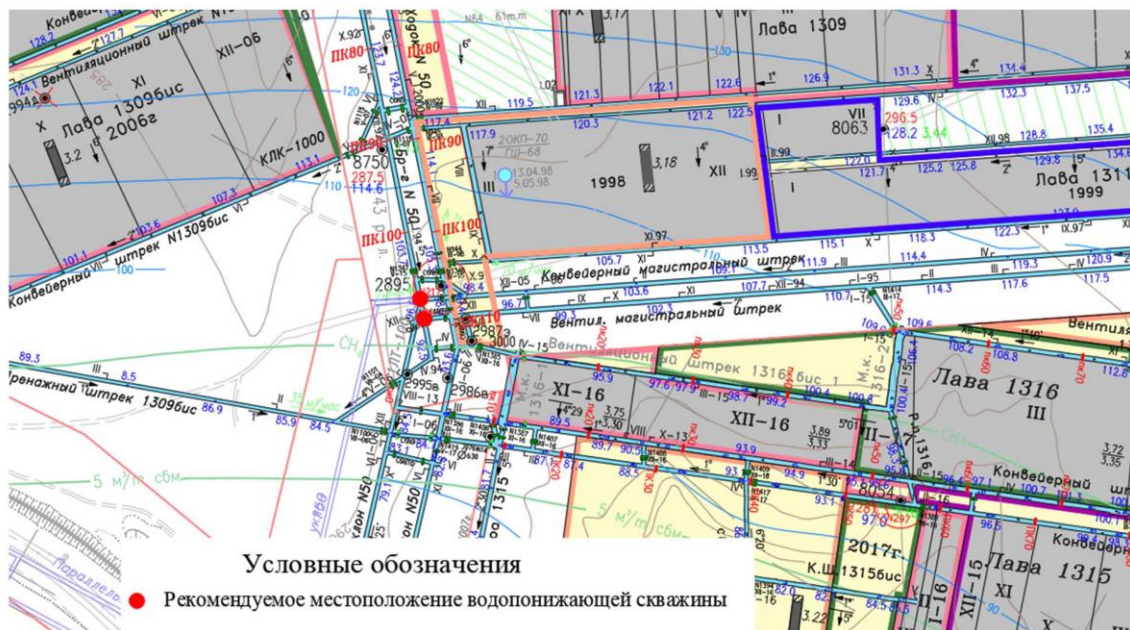
Рисунок 10.6 – Выкопировка с плана горных работ пласта Грамотейнского II ООО «Шахта «Листвяжная» (рекомендуемое местоположение водопонижающей скважины)
