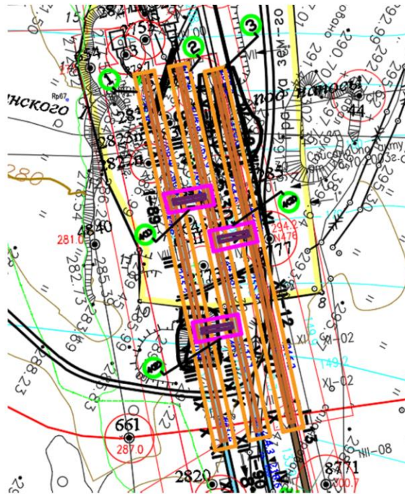
Рисунок 12.8 – Область опасных зон от подготовительных и капитальных выработок пласта Грамотейнского I в районе Листвяжной р.л.
