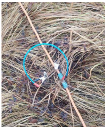
Рисунок 4.9. Инсталлирование и коммутация электродов в почвенно-растительный слой
