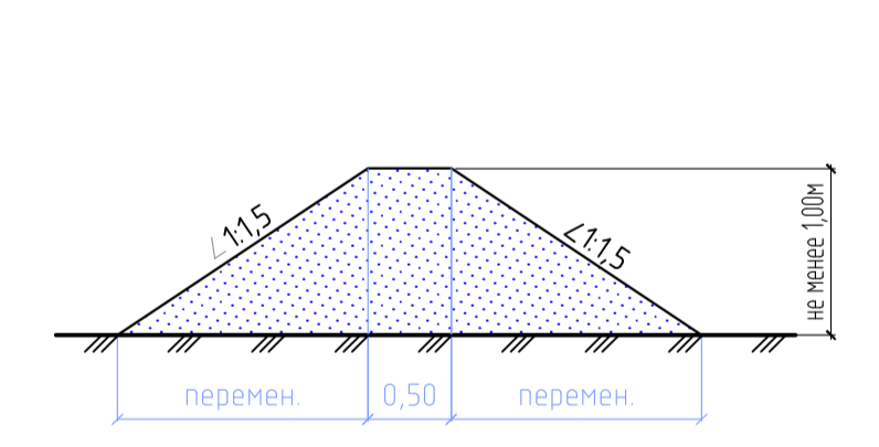
Конструктивный поперечный профиль обвалования
