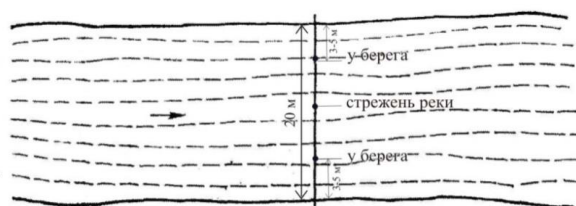
Рисунок 2 - Схема разбивки створа при отборе проб на водотоке шириной более 20 м.
