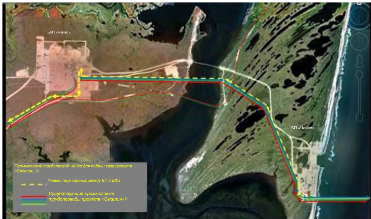
Рисунок 7.4-1: Трасса промышленного газопровода
