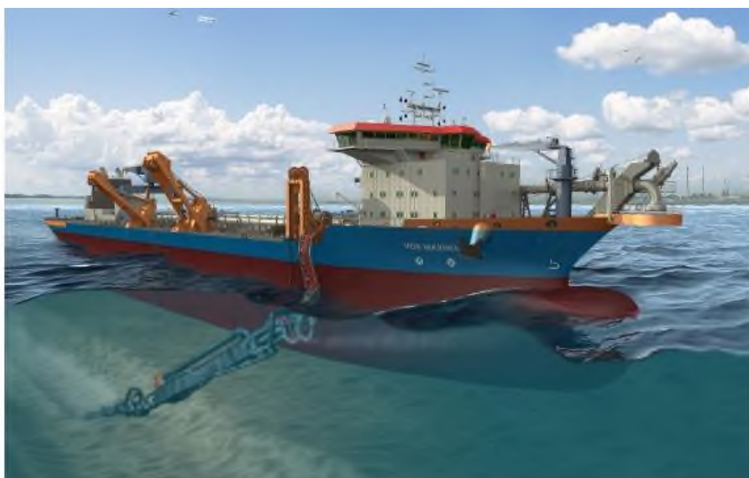
Рисунок 3.2-9: Земснаряд с волочащимся грунтоприемником
