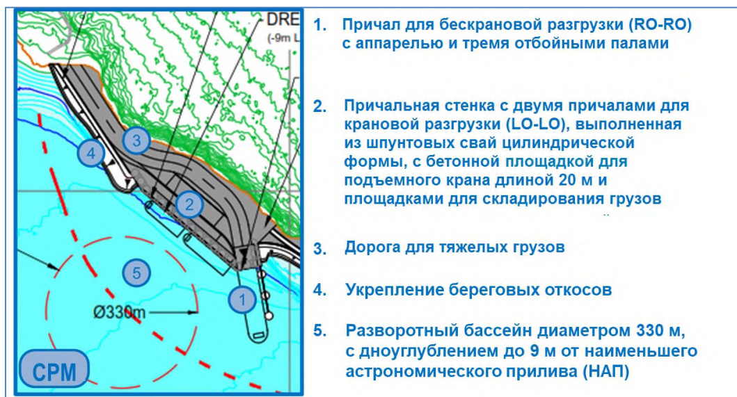
Рисунок 3.3-5: Сооружения для разгрузки материалов
