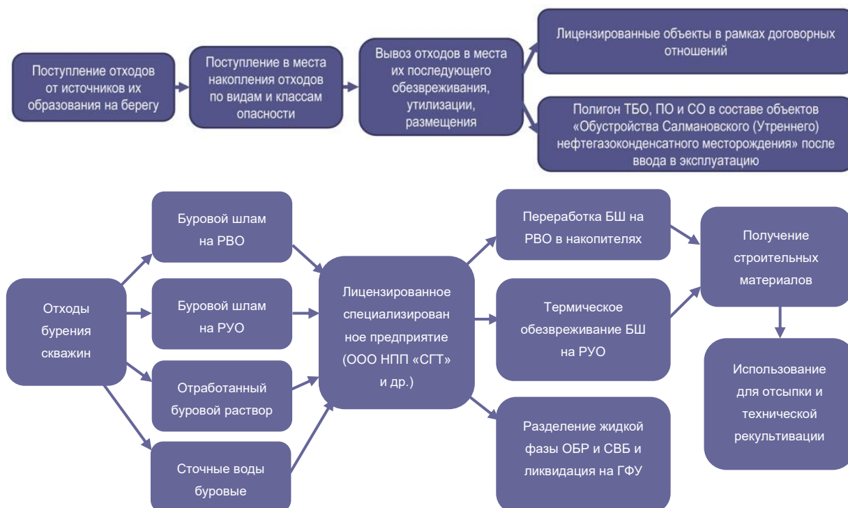
Рисунок 9.7.1: Обобщенная схема обращения с отходами в процессе строительства и эксплуатации объектов Проекта и ассоциированных объектов
