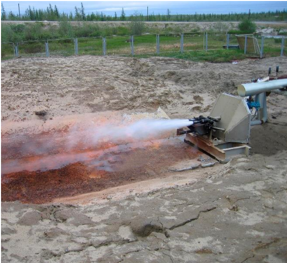
Рисунок 5.9: Установка ГФУ-5 для утилизации очищенных сточных вод
