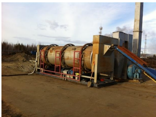
Рисунок 5.11: Установки УПНШ (слева) и «Фортан» для обезвреживания отходов бурения, содержащих углеводороды
