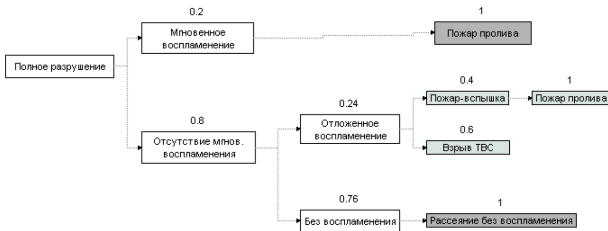
Рисунок 3 - Дерево событий при полной разгерметизации трубопроводов (Методика определения расчетных величин пожарного риска на производственных объектах)
