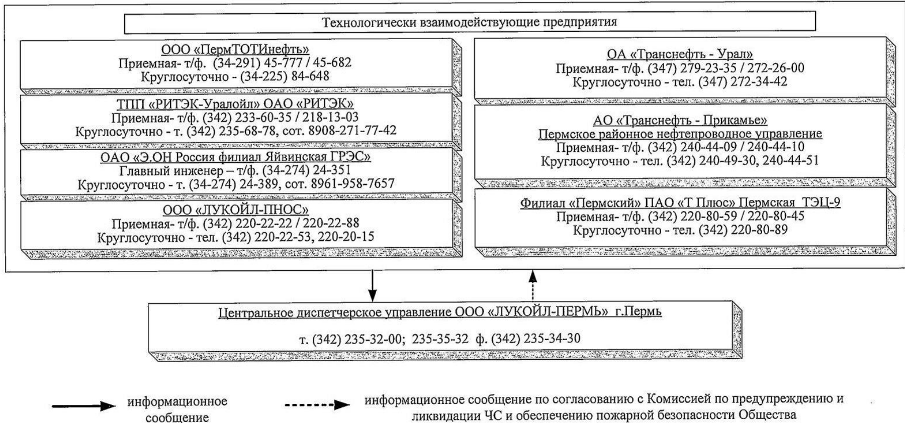
Рисунок 12 - Схема оповещения технологически взаимодействующих предприятий при несчастных случаях, техногенных событиях и чрезвычайных ситуациях, угрозах совершения и совершении актов незаконного вмешательства на объектах ООО «ЛУКОЙЛ-ПЕРМЬ»
