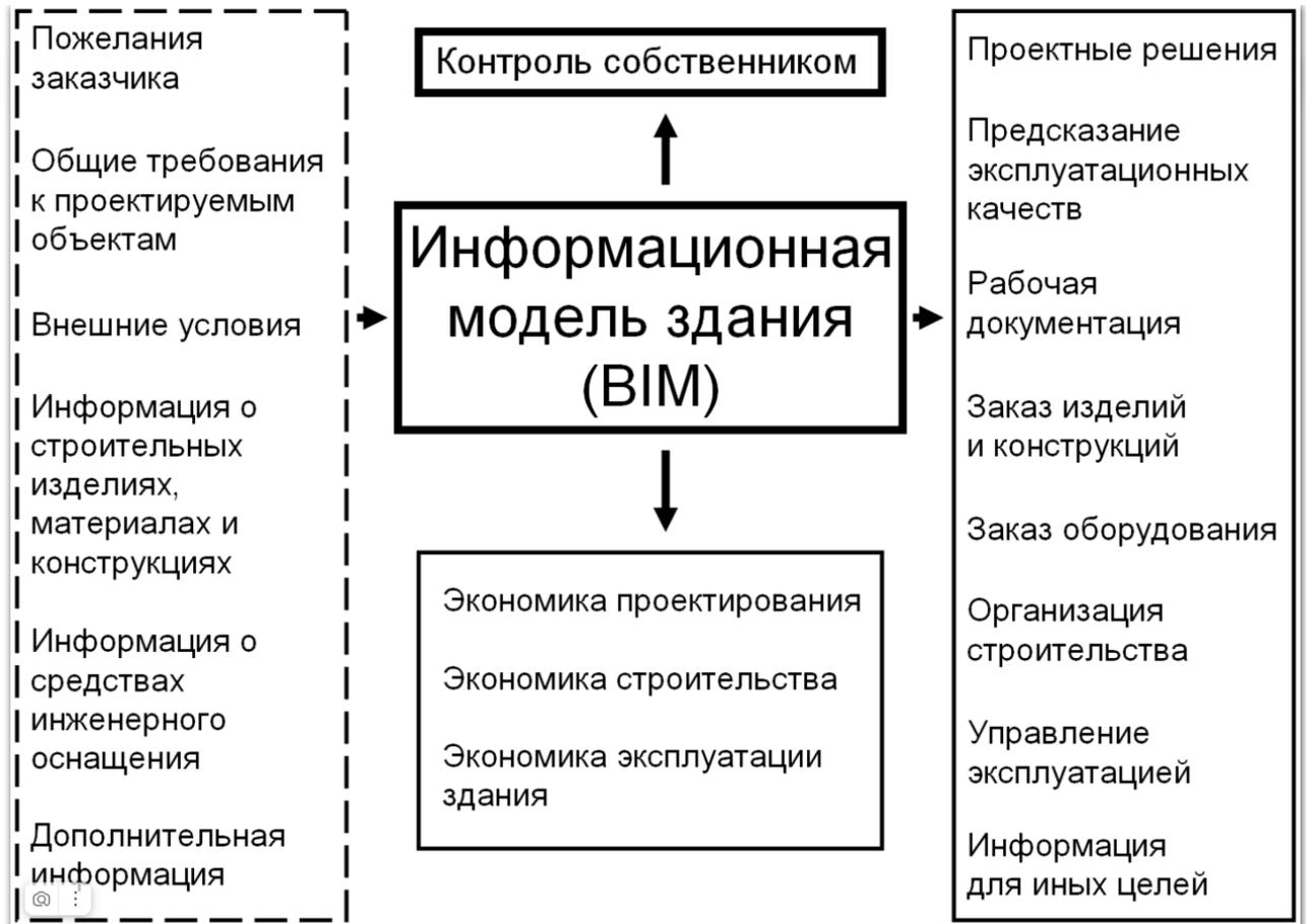
**Рис.2. Схема информационного BIM-моделирования зданий и сооружений**
