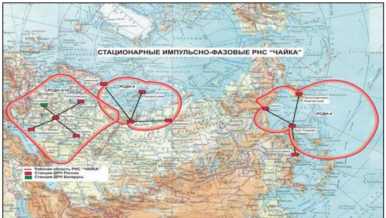
Рисунок 11. Зоны действия РНС «Чайка»
