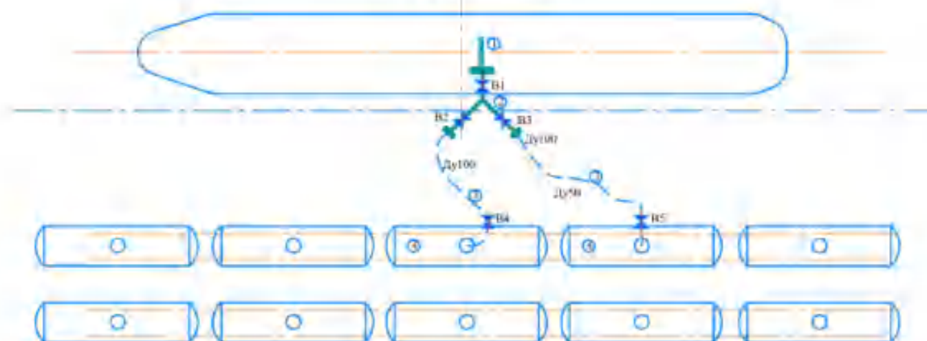
Технологическая схема выгрузки танкера
