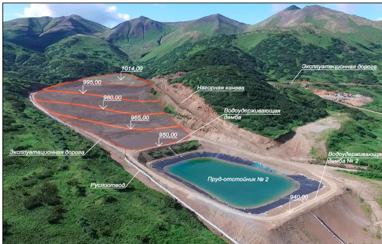
Рисунок 1 – Схема накопителя отходов обогащения ЗИФ (проектное положение)
