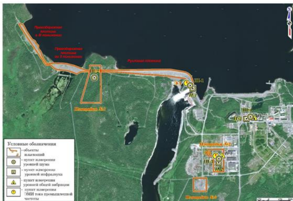
Р и с у н о к 3.9 – Местоположение точек измерения уровней ЭМИ, шума, инфразвука и вибрации
