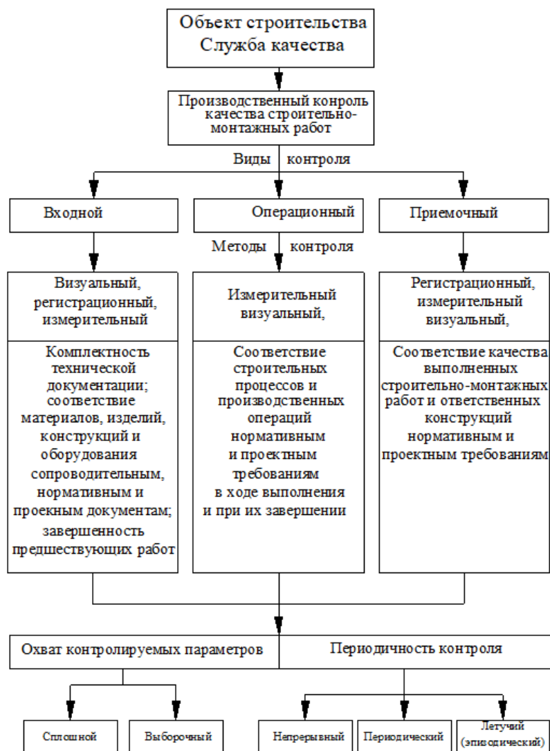
Рисунок 1 – Схема производственного контроля качества строительно-монтажных работ.
