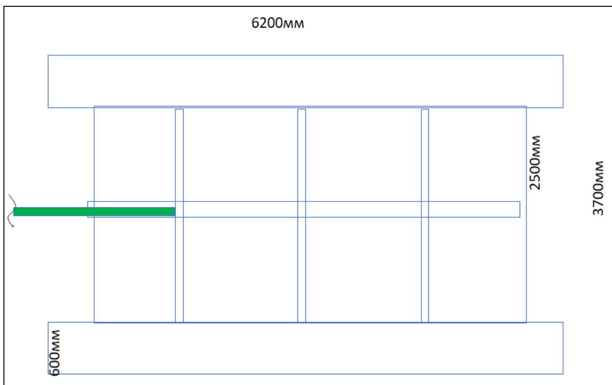
Рисунок 2.1-16. Судно – источник катамаран и система подвеса мелководной группы истчников – понтон (чертеж)
