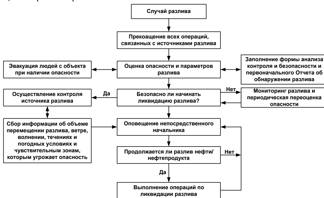
Рисунок 9.4-1. Схема ликвидации разлива нефтепродукта
