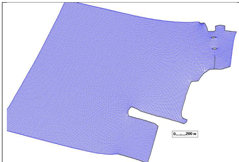
Рисунок 4.3 – Расчетные сетки локальной модели
