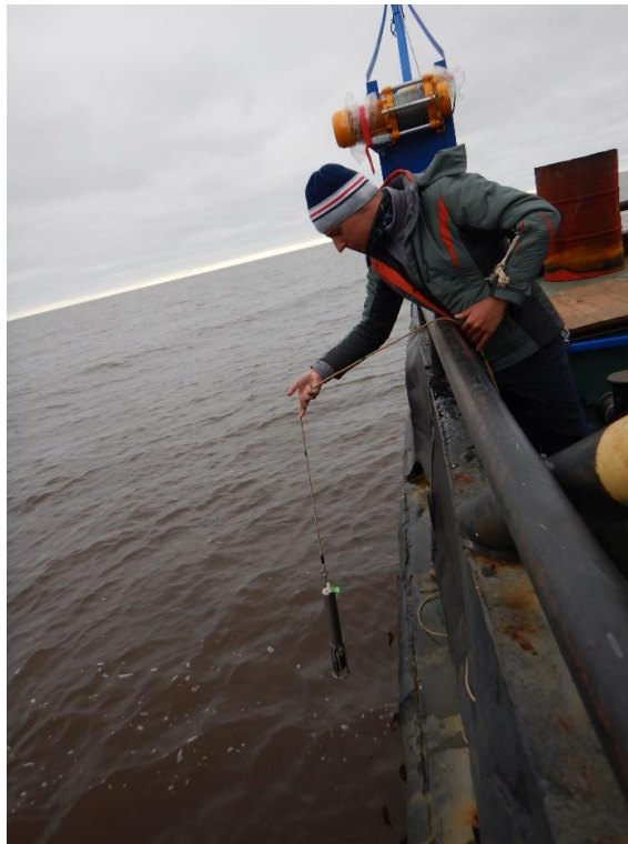
Рисунок 8.4-11. Измерение термохалинных характеристик зондом CTD-48M Sea & Sun Technology
