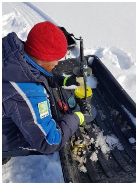
Рисунок 8.4-5. Испытание кернов льда на сжатие на испытательном гидравлическом прессе
