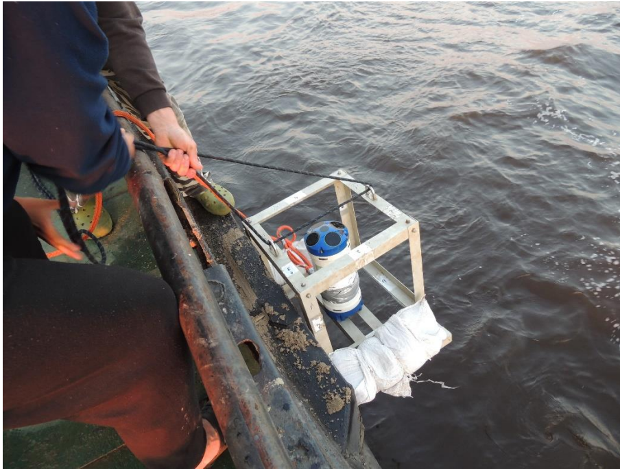
Рисунок 8.4-10. Установка АДС на основе ADCP на точке.
