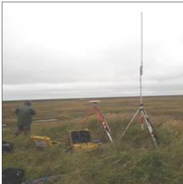
Рисунок 6.4-9. Пример установки береговой базовой станции над центром знака
