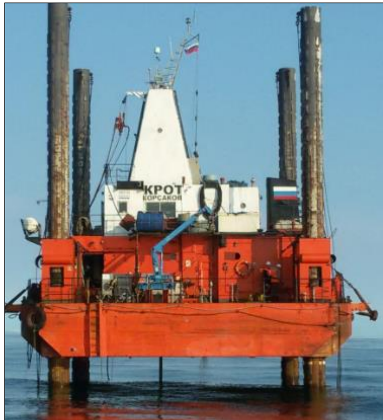
Рисунок 5.1-4. Самоподъемная буровая платформа «Крот»
