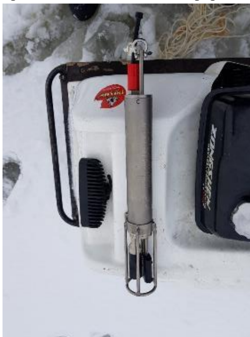
Рисунок 8.4-8. Зонд CTD-48M Sea & Sun Technology, использующийся для измерения параметров морской воды
