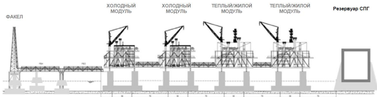
Рисунок 1.1-2. Схематическое изображение СПГ завода прибрежного исполнения на гравитационных основаниях
