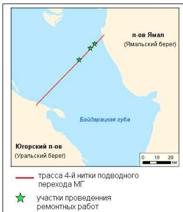
Рисунок 4.2.1 – Схема расположения трассы четвертой нитки подводного перехода магистрального газопровода «Бованенково-Ухта» через Байдарацкую губу (из материалов инженерных изысканий, переданных ООО «Газпром трансгаз Ухта» в рамках договора № 0441.051.001.2019/2 от 26.12.2019 г.)
