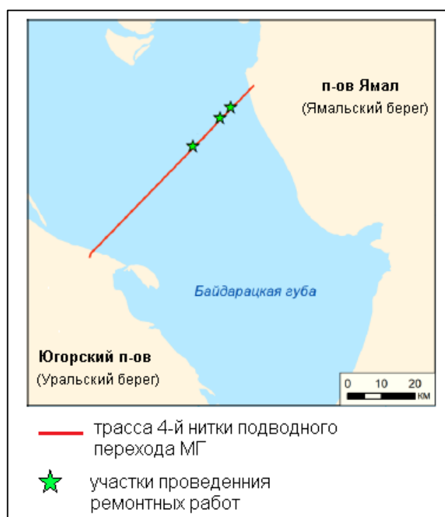
Рисунок 4.2.1 – Схема расположения трассы четвертой нитки подводного перехода магистрального газопровода «Бованенково-Ухта» через Байдарацкую губу
