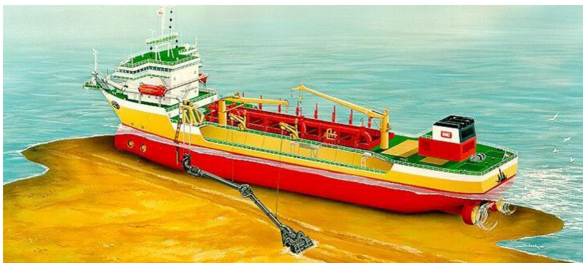
Рисунок 10.1.3.1 – Разработка слоя грунта самоотвозным земснарядом
