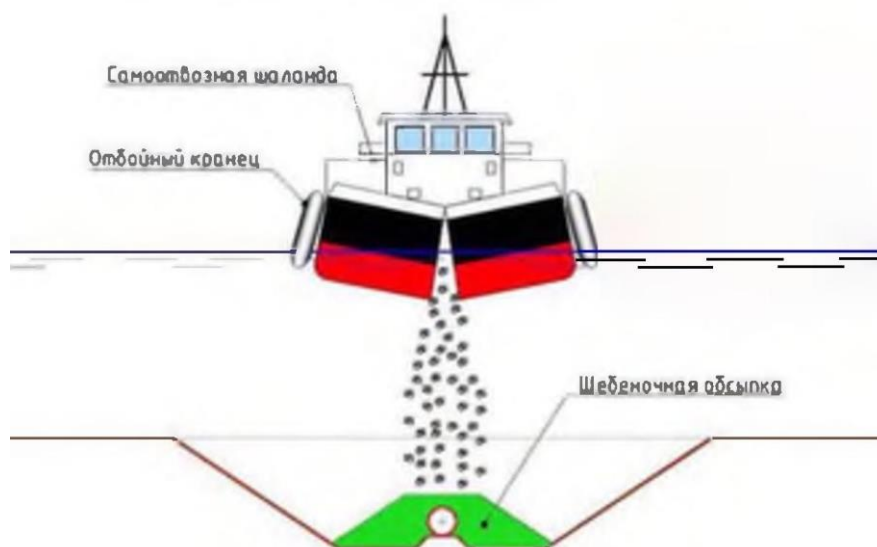
Рисунок 10.1.6.2 – Схема обсыпки трубопровода щебнем
