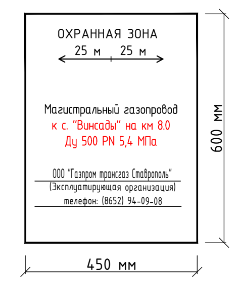
Столбик опознавательный с табличкой (Правила технической эксплуатации линейно-кабельных сооружений междугородных линий передач)
