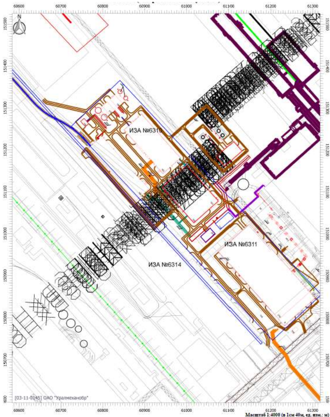
Рисунок 10 – Схема источников выбросов загрязняющих веществ на период строительства зданий и сооружений участка производства и нейтрализации серной кислоты и здания центрального теплового пункта
