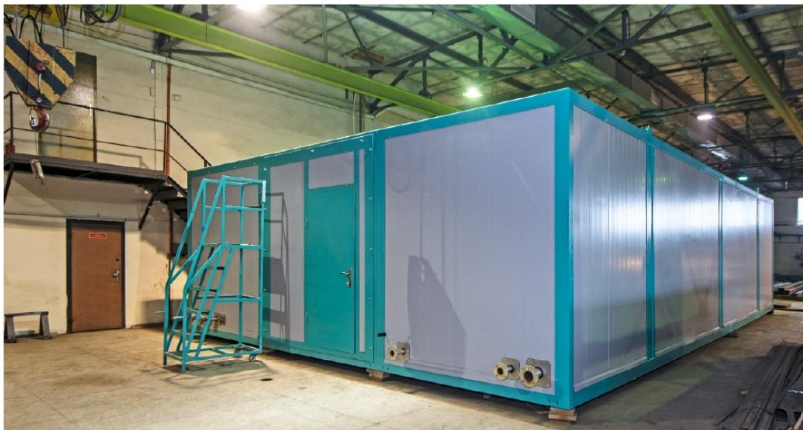
Рис.5 Блок модуль для расположения оборудования
