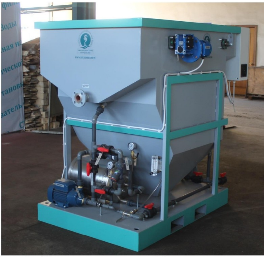
Рис.6 Флотатор производительностью 2м3/ч углеродистая сталь.
