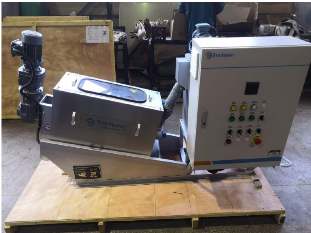
Рис.10 Установка обезвоживания осадка
