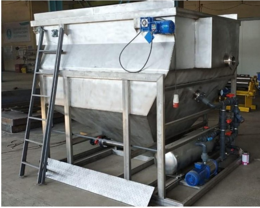
Рис.7 Флотатор производительностью 15м3/ч нержавеющая сталь.
