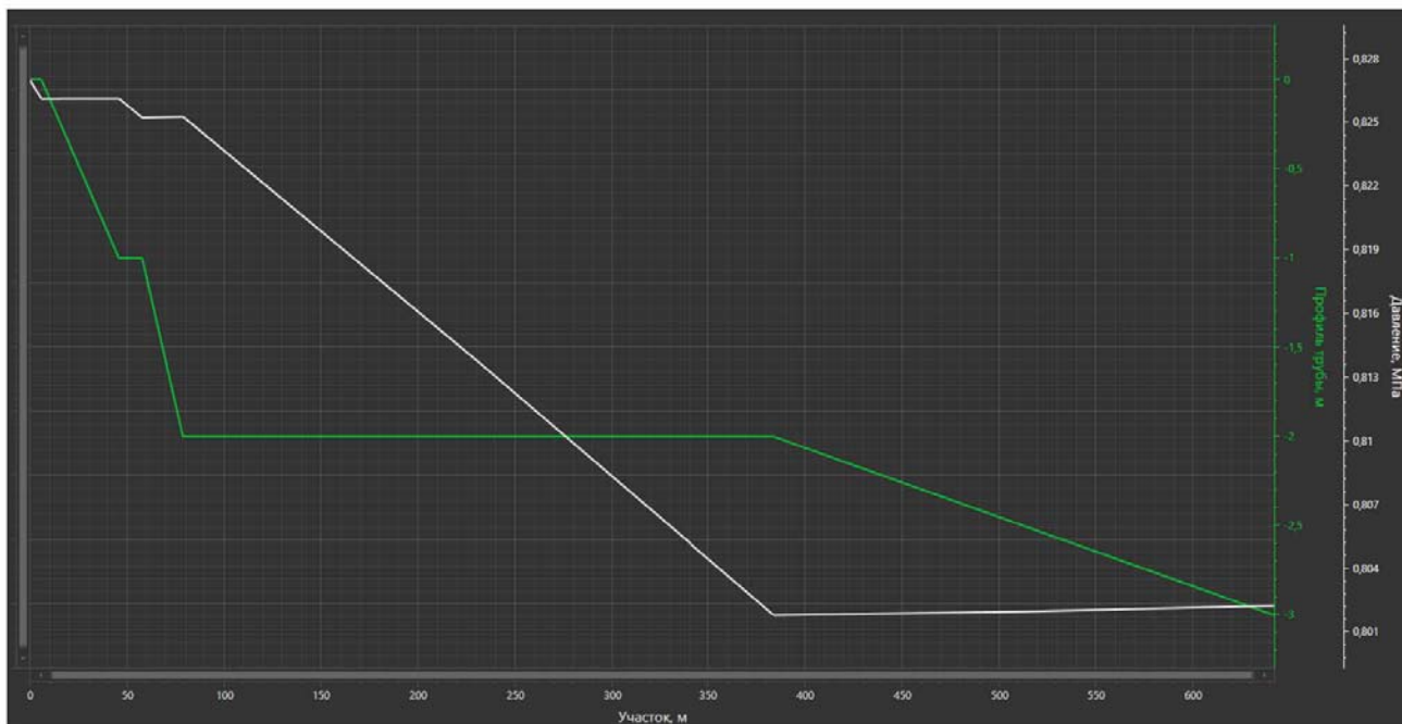
Рисунок 1.3.2 – Распределение давления по трубопроводу «ГЗУ-1220 – блок задвижек», вариант 1, участок 1
