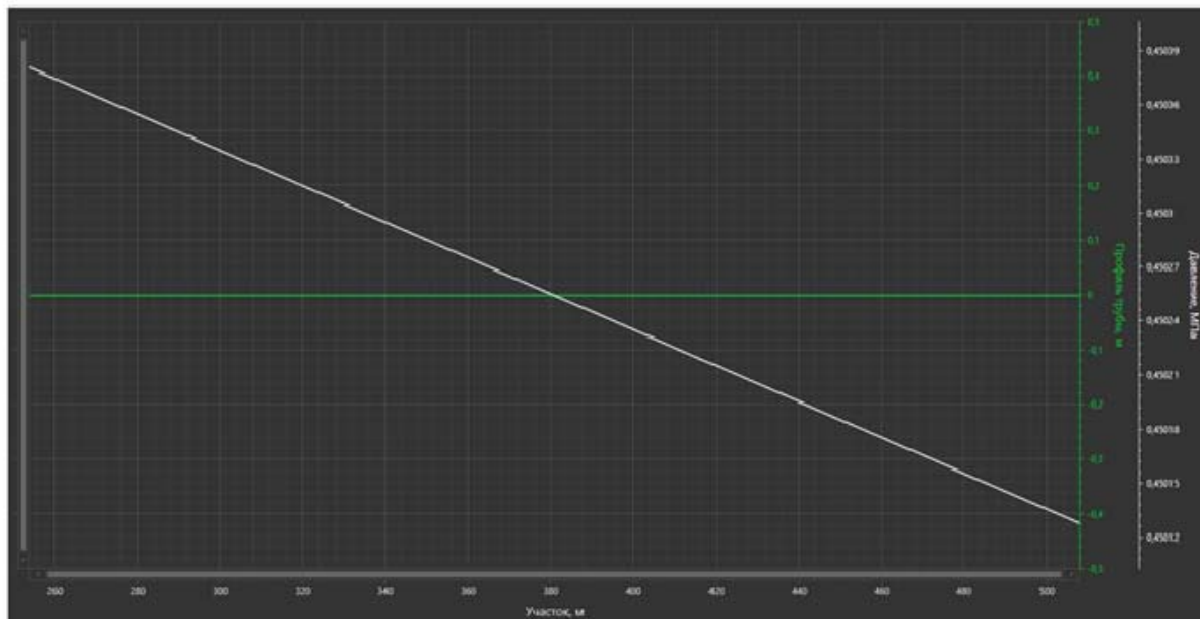
Рисунок 1.3.12 – Распределение давления по трубопроводу «ГЗУ-1220 – блок задвижек», вариант 4, участок 2
