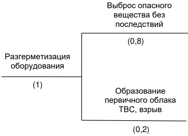
Рисунок 3 – «Дерево событий» в результате разгерметизации оборудования, содержащего опасное вещество
