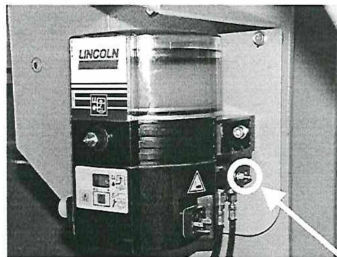
Рис. 6: Смазочный ниппель для аварийной смазки
