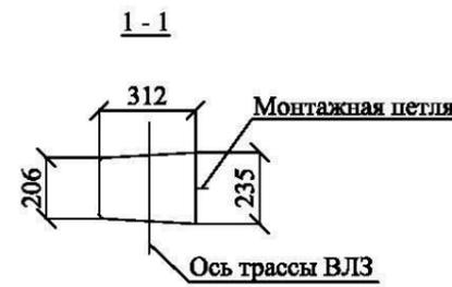
Схема установки промежуточных опор на ВЛЗ
