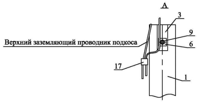
Схема установки на ВЛЗ анкерной опоры
