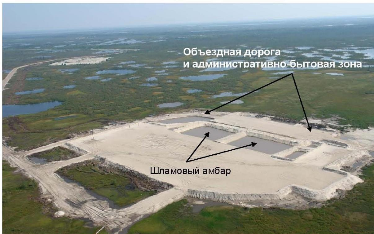
Рисунок 1 – Современная конструкция существующей площадки куста скважин со шламовым амбаром
