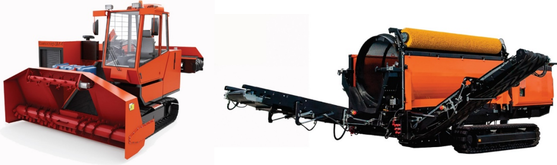
Рисунок 2.4 – Вспомогательные механизмы участка компостирования (Ворошитель и грохот компоста)
