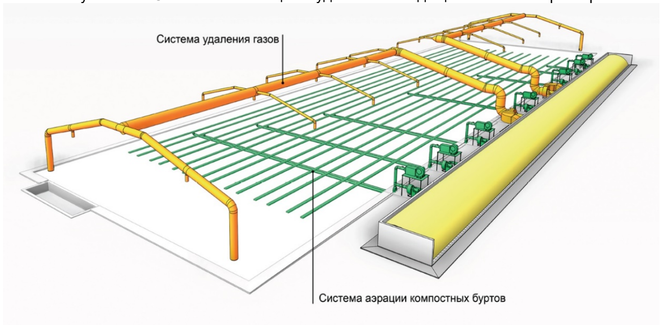
Рисунок 2.3 – Система вентиляции и удаления отходящих газов в биофильтр
