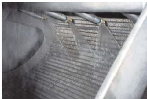
Данные барабанные решетки обеспечивают эффективную механическую очистку от крупных загрязнений и мусора в непрерывном автоматическом режиме. Для уменьшения объемов, образующихся твердых отходов рекомендуется использовать транспортер со встроенным гидравлическим прессом.
