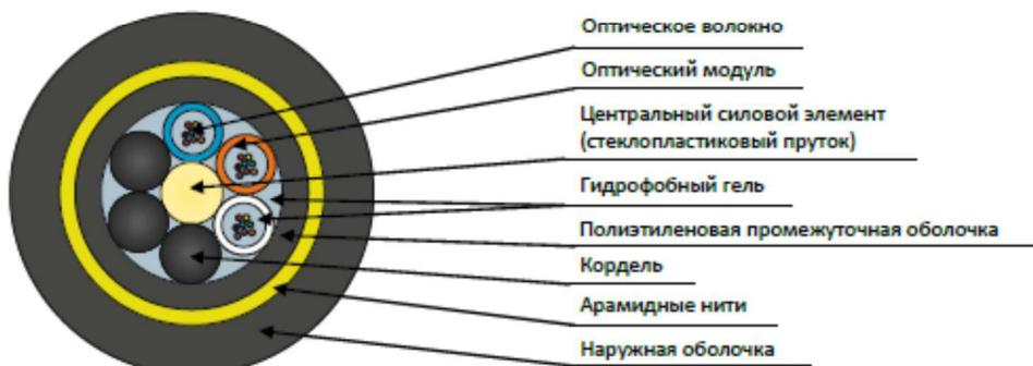
Кабель содержит сердечник модульной конструкции с центральным силовым элементом из диэлектрического стержня, вокруг которого скручены оптические модули со свободно уложенными волокнами. Свободное пространство в оптических модулях и в сердечнике кабеля заполнено гидрофобным гелем. На сердечник накладывается промежуточная оболочка из полиэтилена. На промежуточную оболочку спирально накладываются арамидные нити. Поверх нитей накладывается оболочка из полиэтилена средней плотности.
